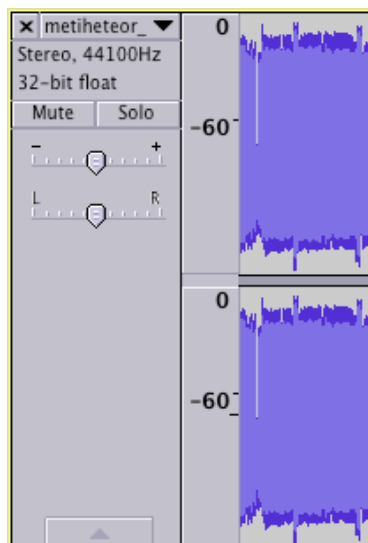
A felső csúszka a hangerő, alatta a sztereó pozicionálás
